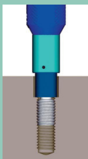
Durchmesserreduzierung für vertiefte Bohrungen.
