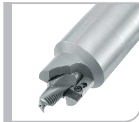
Kombinationswerkzeug mit Bohr­gewindefräser M 16 x 1,5 stirnschneidig und einer PKD bestückten Konturplatte zur Bearbeitung einer vorgegossenen Bohrung
